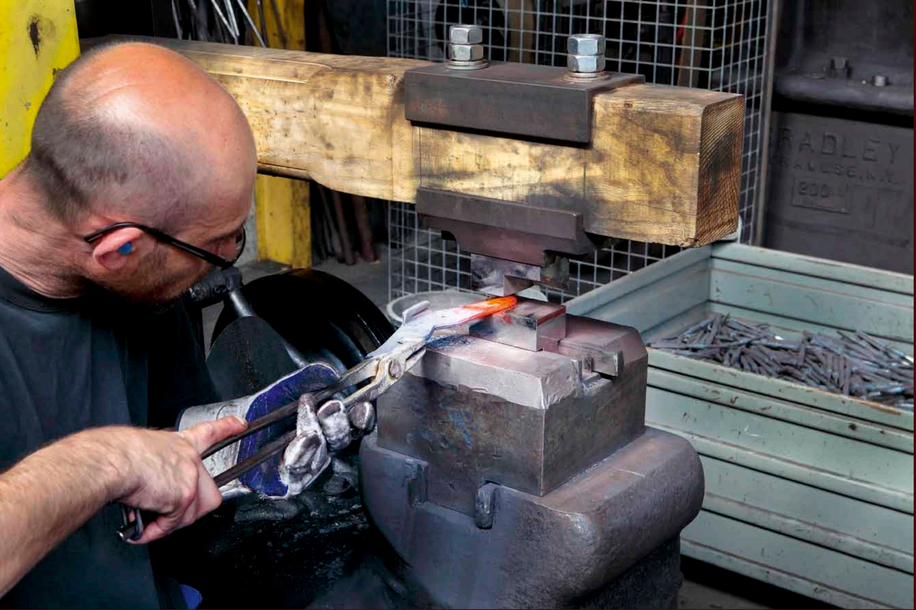
Mise en forme des outils par étampage à chaud. Ce marteau Bradley (modèle compact déposé en 1870) a été fabriqué en 1910 à New-York. Il est utilisé dans la taillanderie depuis 1910. Tous les outils sont réalisés à la main avec un outillage traditionnel et à partir d'aciers de haute qualité forgés sur place.
