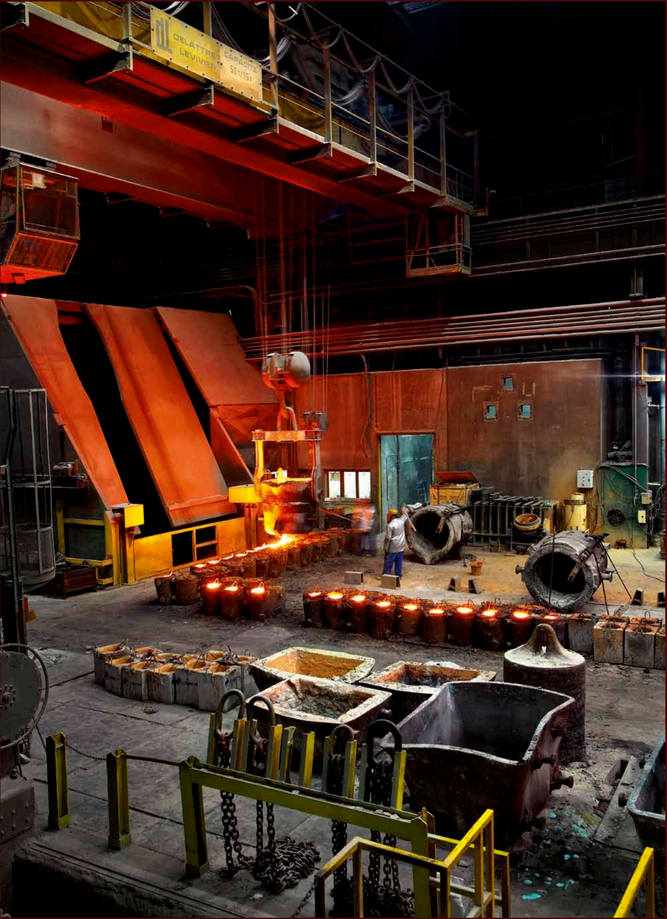
Atelier de fusion, coulée d'acier. La fonderie est un procédé de formage des métaux qui consiste à couler un métal ou un alliage dans un moule afin de reproduire une pièce dans ses moindres détails en limitant, autant que possible, les opérations de finition après refroidissement. Pour cela, le métal est chauffé jusqu'à devenir liquide. C'est ce qu'en métallurgie on appelle la fusion.
