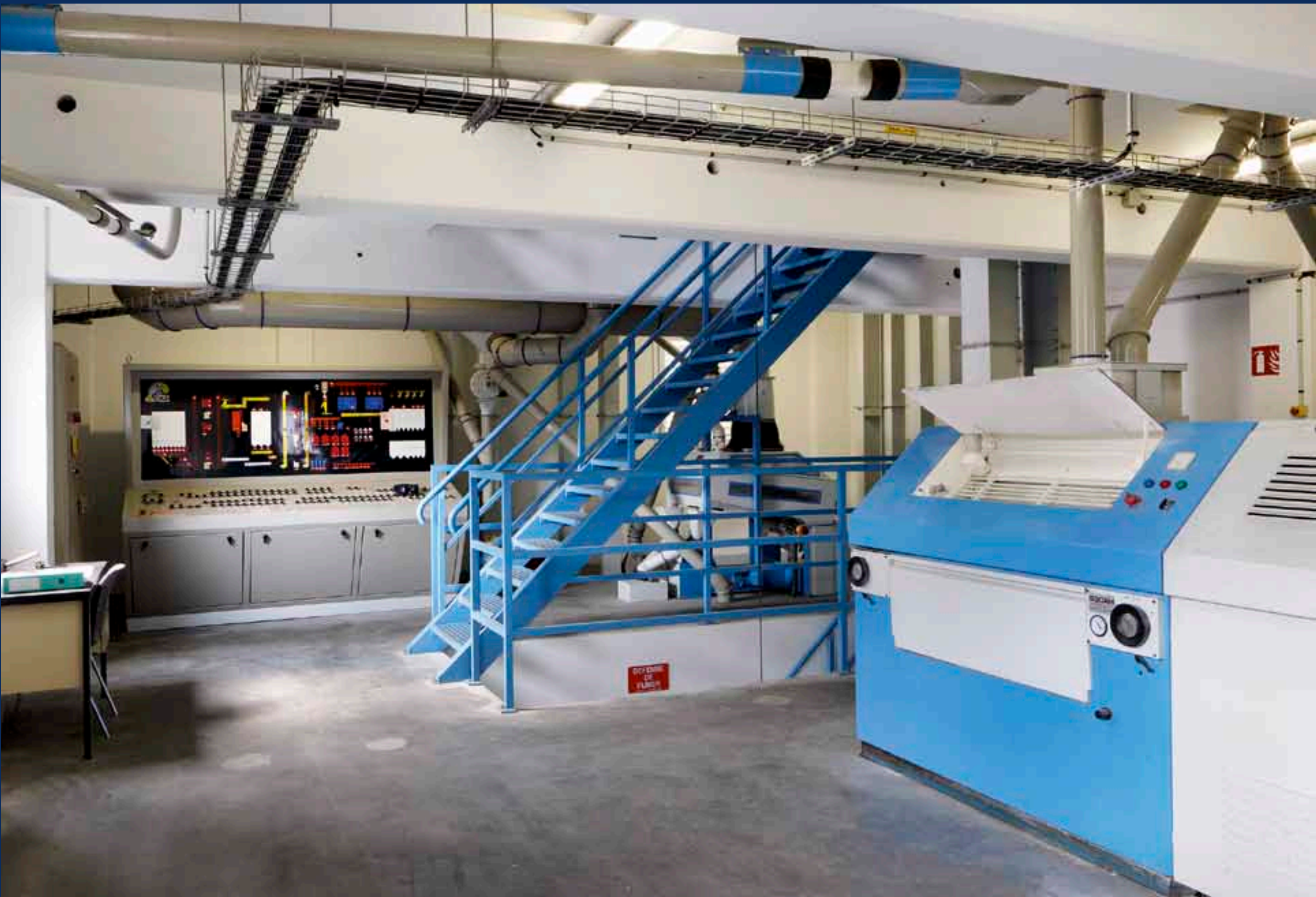
Salle de contrôle et broyeurs à cylindres. La table de contrôle permet de visualiser le déroulement de la production et le bon fonctionnement de tous les appareils de la minoterie. Les broyeurs à cylindres assurent l'écrasement du grain.
