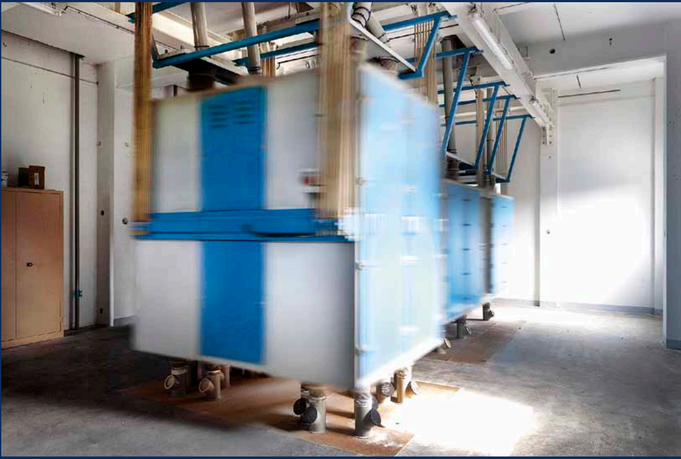
Planchister en fonctionnement. Les planchisters servent à tamiser la mouture après chaque passage dans les broyeurs. A l'intérieur de ces armoires métalliques suspendues à de simples tiges de bois (roseau, if ou bambou) se trouve un système complexe de tamis. Lorsqu'ils sont en marche, les planchisters ont un mouvement circulaire horizontal très rapide. Pour supporter leur poids et leurs vibrations, la structure béton du bâtiment est renforcée par des poutres métalliques.
