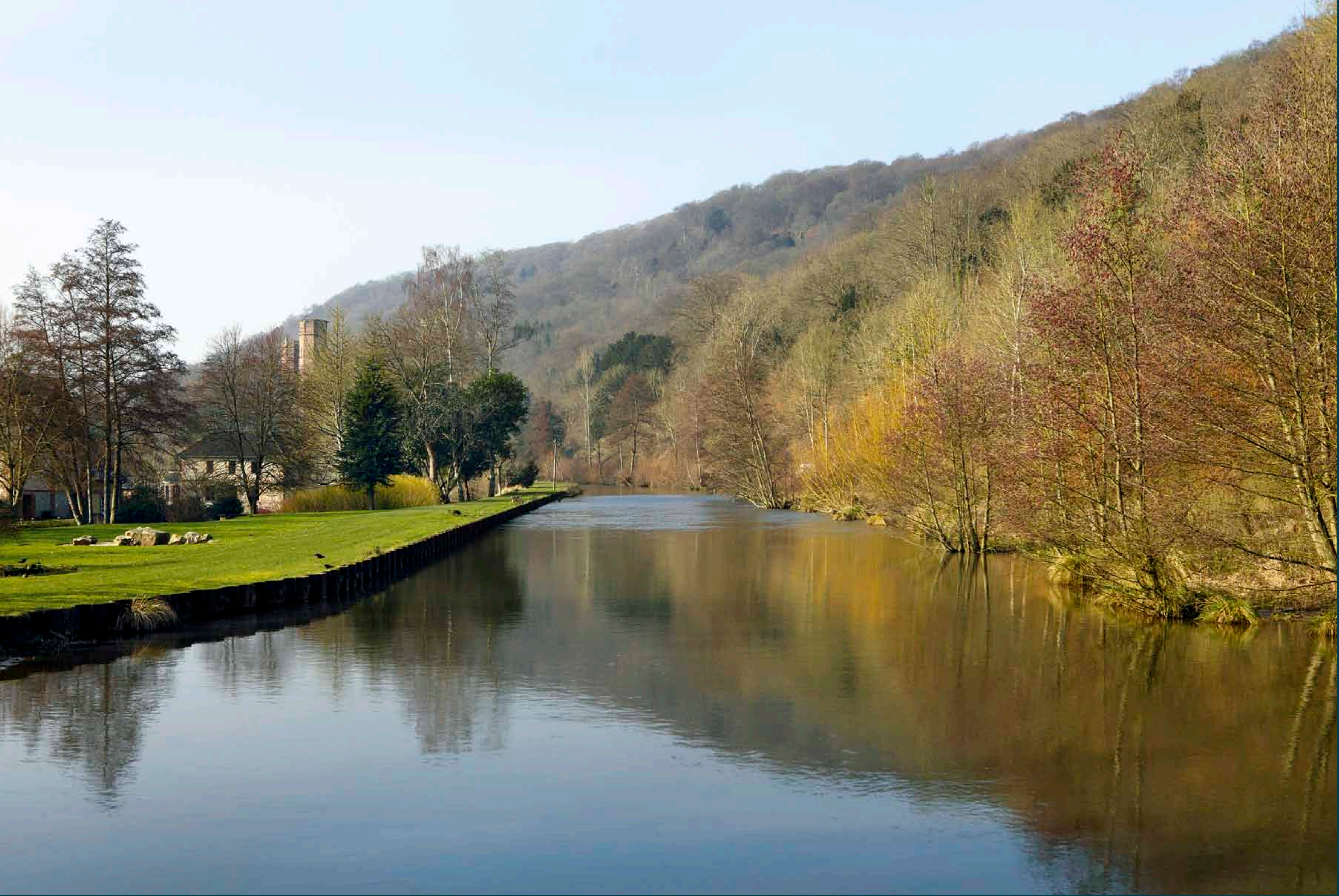
Pont-Saint-Pierre. Filature Levavasseur. Son canal de dérivation est de loin le plus imposant construit sur l'Andelle. Il mesure plus de 500 m de long et de 10 à 15 m de large.
