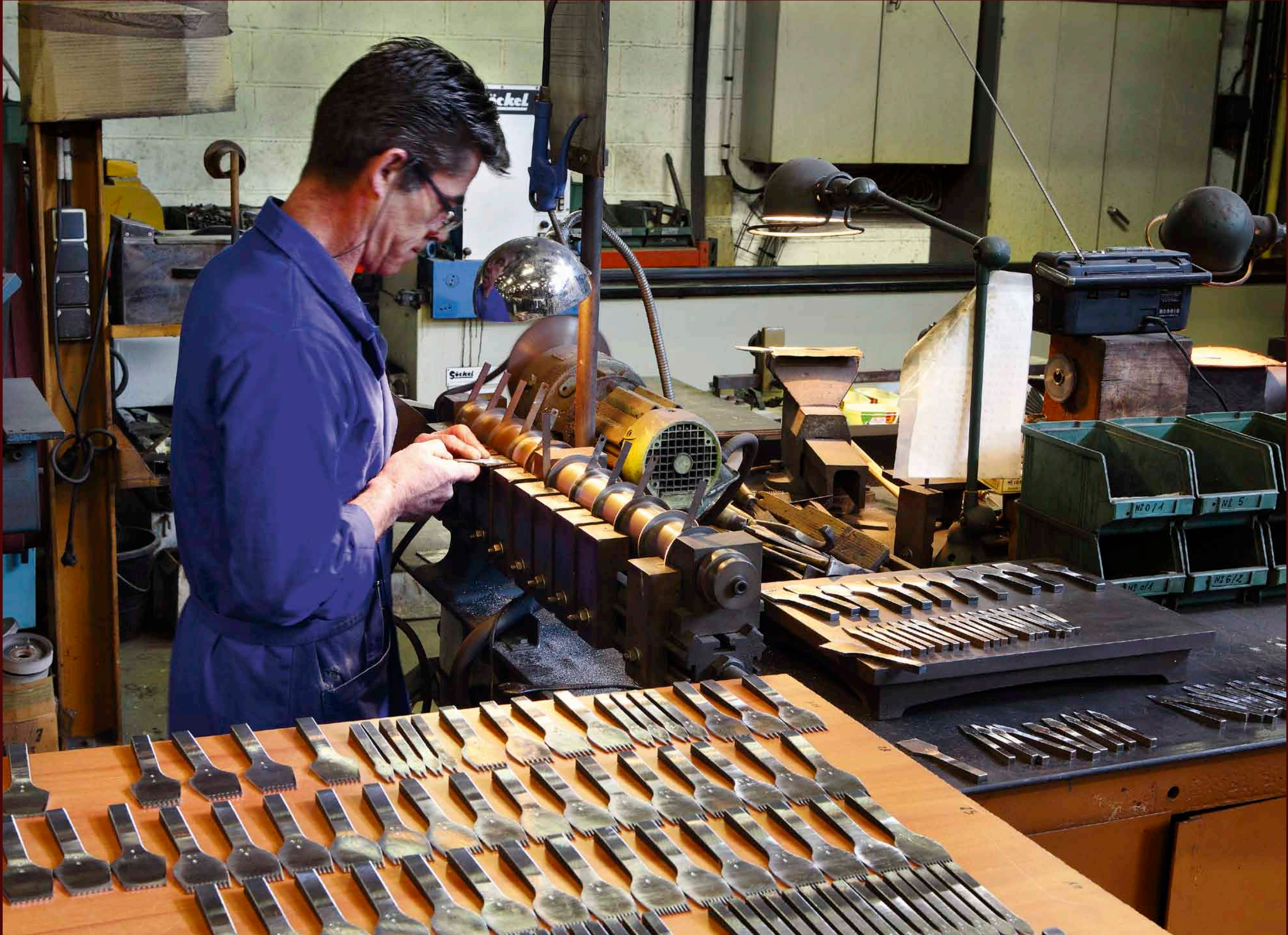
Fabrication de griffes à frapper le cuir utilisées pour marquer les points de couture en sellerie-bourrellerie. La taillanderie occupe aujourd'hui près de quinze personnes très qualifiées qui assurent toutes les étapes de fabrication, de l'étampage au polissage... Ce savoir-faire donne aux outils une qualité de coupe, une prise en main, une résistance et une esthétique qui font leur succès dans le monde entier.
