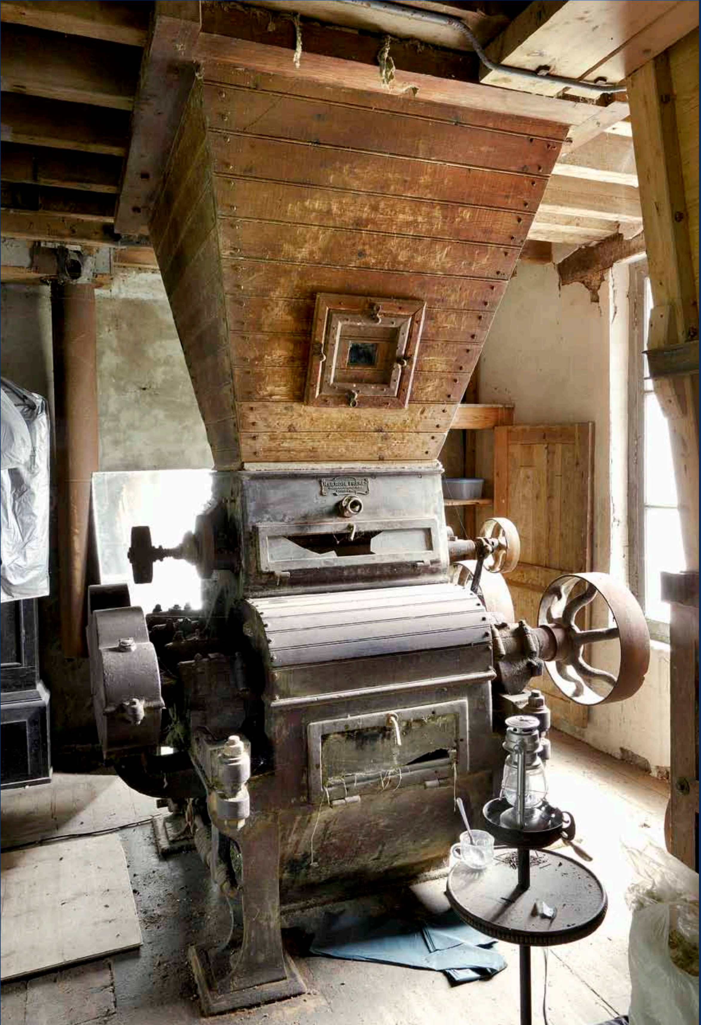
Blainville-Crevon. Minoterie Grivet. Les broyeurs à cylindres, tels que celui-ci, ont remplacé à la fin du XIX e siècle les meules traditionnelles en pierre pour l'écrasement des grains.
