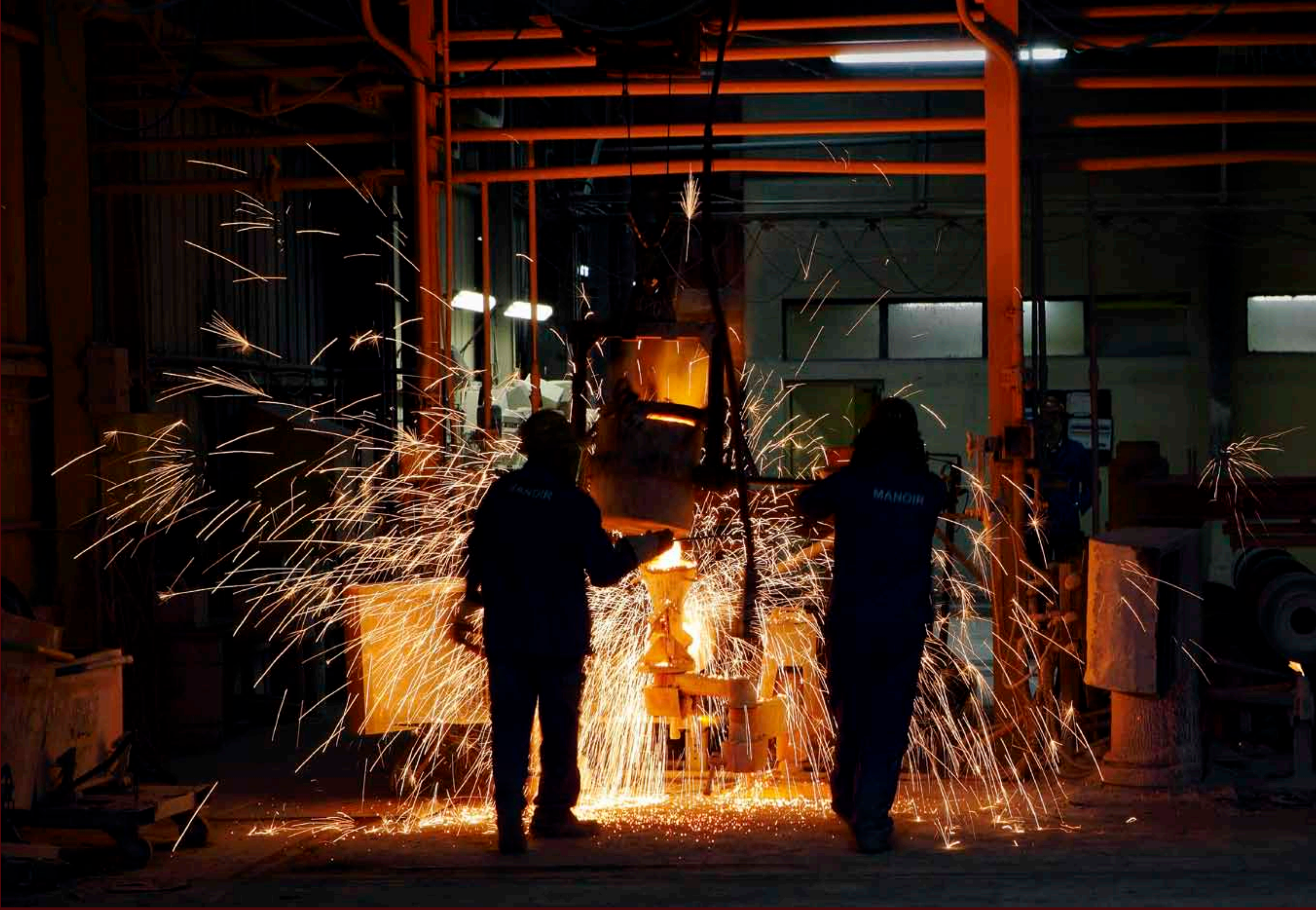
Atelier de centrifugation, fusion d'acier. À la fin des années 1960, l'usine est capable de réaliser des pièces en acier moulé dans pratiquement toutes les techniques de moulage (cire perdue ou céramique) et tous les alliages, entre 1 kg et 20 tonnes, y compris en centrifugation, horizontale ou verticale. Elle se spécialise alors dans les fournitures de tubes, vannes et éléments de pompe pour la pétrochimie et le nucléaire (pièces internes des réacteurs, tuyères...).
