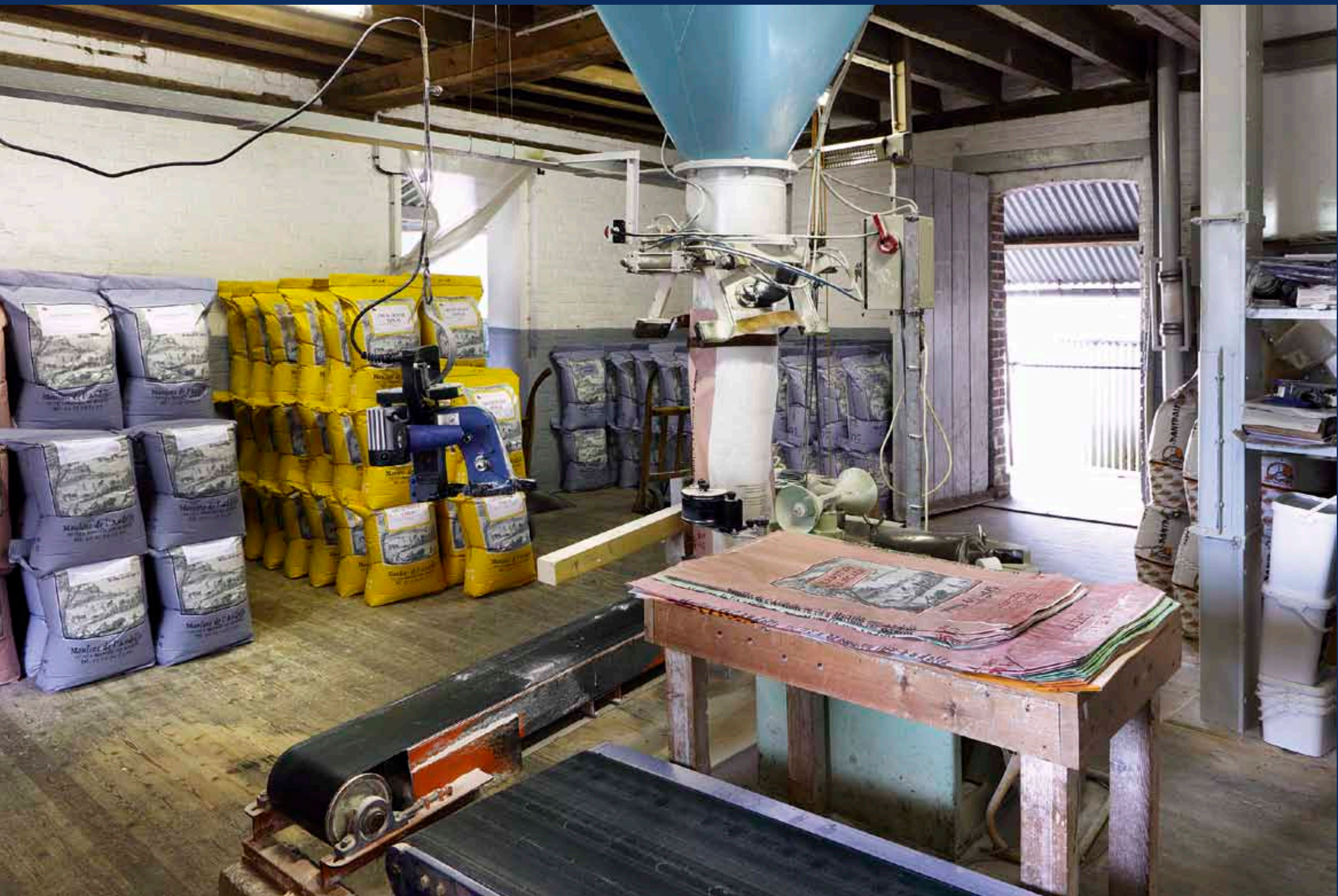
Salle d'ensachage et de pesée. Ces opérations finales sont effectuées dans le moulin primitif. Aujourd'hui, la minoterie Mouchard emploie douze personnes et possède une capacité d'écrasement de 1 100 quintaux de blé par jour.
