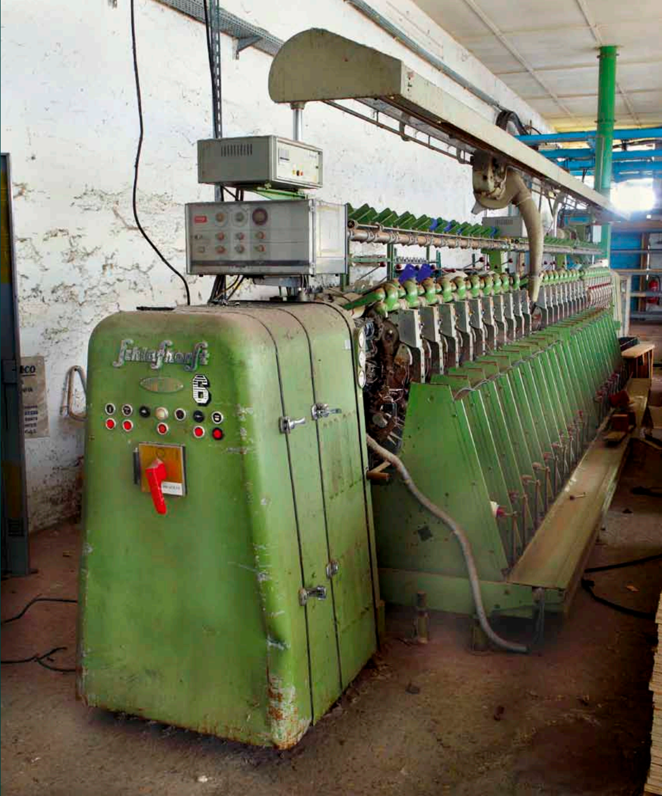
Banc à broches de marque allemande schliothorst acheté dans les années 1970. Cette machine sert à dériver, affiner et tordre les mèches de coton. Après la fermeture des Anciens établissements Peynaud en 1986, toutes les machines dédiées au filage et au tissage du coton sont revendues, démontées et expédiées vers les pays en voie de développement. Ce banc à broches est l'un des rares objets techniques encore en place témoignant de l'activité cotonnière dans le bassin de l'Andelle.
